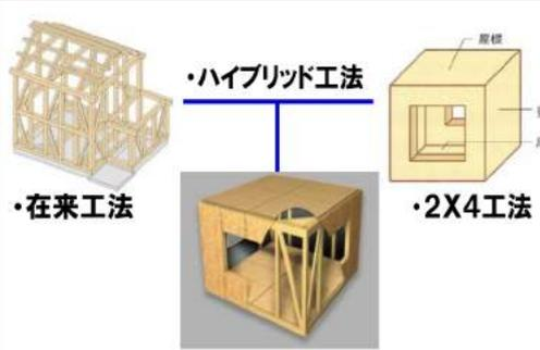
地震の横揺れの力を分散させるため変形を起こしにくく、壁倍率（地震の横揺れに対する強度）2.5倍を実現。
