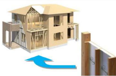
断熱材一体型パネルで建物全体を囲う事で、魔法瓶のような、夏は保冷・冬は保温の役割を果たします。
