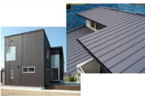
ガルバリウム鋼板製の外壁と屋根を採用する事で、建物が軽くなり、地震時の揺れが軽減されます。
