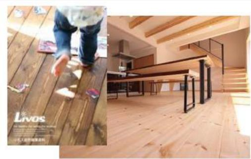
人の肌に直接触れる床には、赤松の無垢床を採用し、その上に自然健康塗料を塗る事でシミ汚れを防止し、メンテナンスを簡単にします。
